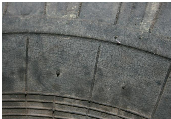
Рис. 3. Растрескивание резины после одного года испытаний / Fig. 3. Cracking of rubber after 1 year of testing
